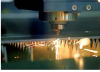
レーザーによる鉄板の切断加工
